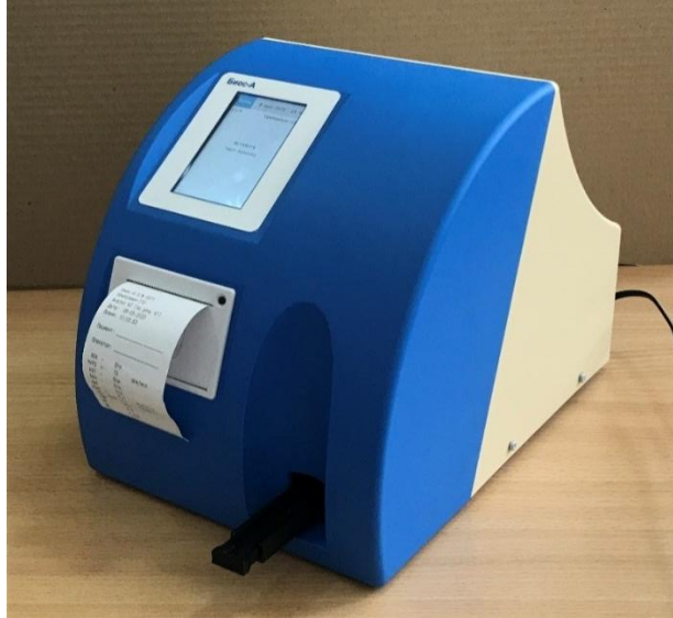
Рисунок 1 – Блок анализатора «Биос-АН-100»
